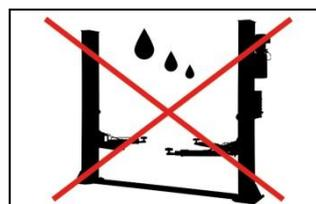
Protéger le pont élévateur contre l'humidité ! Les connecteurs électriques doivent rester secs !
