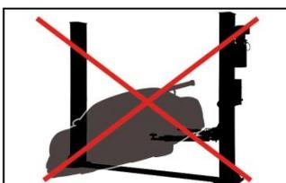
Ne jamais tenter d'appliquer une charge sur seul côté du pont élévateur !
