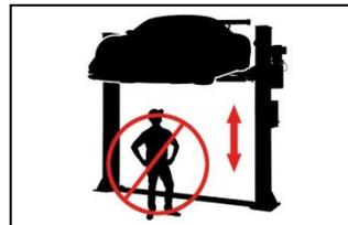
Le stationnement de personnes sous le pont élévateur est formellement interdit (pendant la montée ou la descente) !
