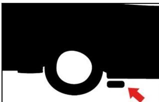
Veuillez aux points d'appui définis par le constructeur du véhicule !
