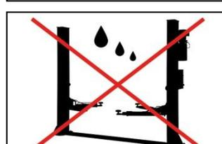
Protéger le pont élévateur contre l'humidité ! Les raccordements électriques doivent toujours rester au sec.
