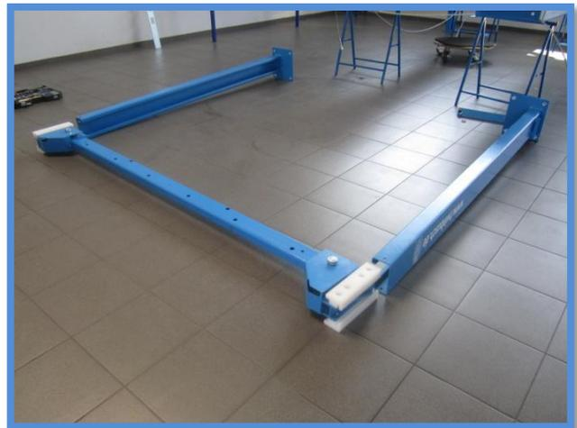
Placez les traverses simultanément dans les deux colonnes.
