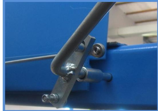
Vissez les écrous sur les tiges filetées, réglez la tension et serrez ensuite les écrous.
