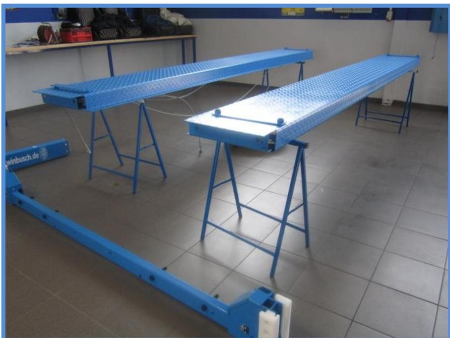
Si possible, veuillez utiliser des tréteaux pour soutenir les deux chemins de roulement.
