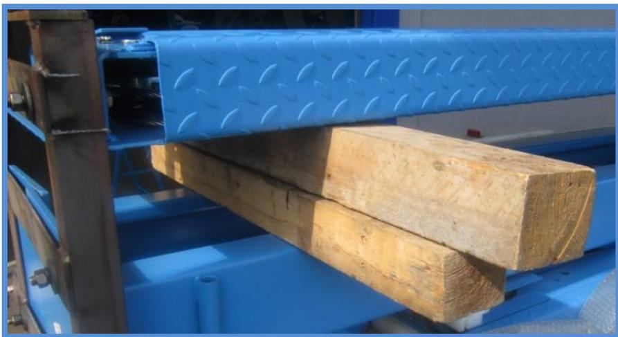
Avant de retirer le cadre de transport, veuillez soutenir le chemin de roulement supérieur au moyen de cales en bois.
