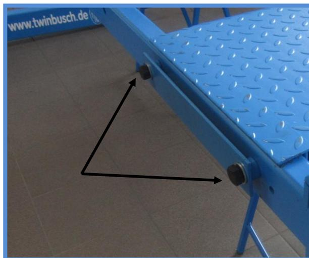
Assemblez les écrous par l'intérieur.
