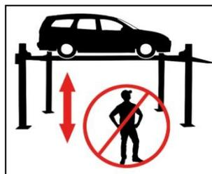
Il est interdit à toute personne de stationner sous le pont élévateur (lors de la montée ou de la descente) !
