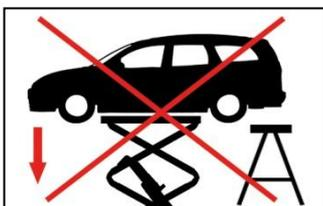
Aucun support additionnel ou objet pouvant entraver le fonctionnement du pont ne doit être présent lors de la descente !
