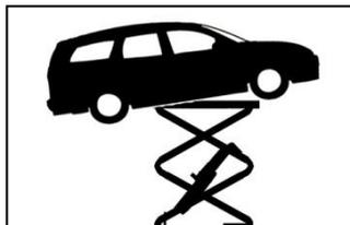
Le poids du véhicule doit être également réparti sur les deux plateformes !
