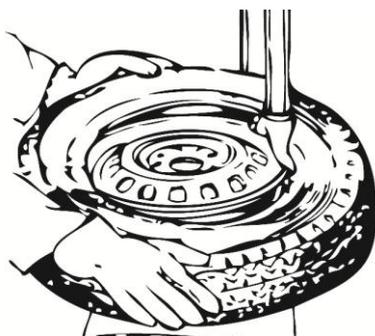
Actionner la pédale de commande des mors de serrage et retirer la jante du plateau.
