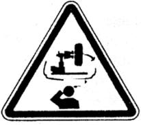
Ne pas rester dans la zone si la roue est bloquée sur la machine et levé du sol.
