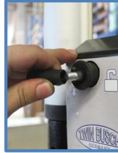
Monter la butée du détalonneur et serrer l'écrou correspondant au bout de la tige du vérin. Visser le joystick de commande de bras d'assistance.
