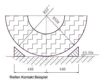
Positionieren Sie eine Säule an eine Radposition zum Anheben. So ausrichten, dass die Gabeln sich unter dem Reifen befinden und das Gerät so weit wie möglich nach vorne geschoben ist, Abb. 3. Gewährleisten Sie, dass die Gabelbreite richtig an die Reifen/ Rad große angepasst wurde. Schalten Sie den Netzschalter ein,
