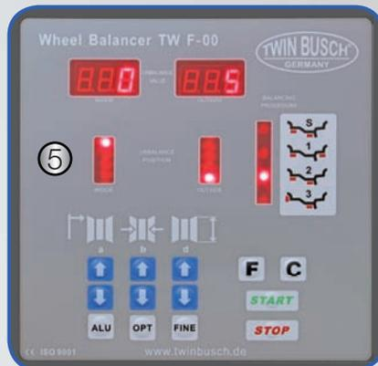
(1) Fixations latérales pour cônes de centrage et compas de mesure (2) Bras de mesure de déport intégré (3) Pince de serrage rapide Ø = 40 mm (4) 15 emplacements pour consommables (5) Ecran à leds (le nouveau design améliore la lecture des données et offre une ergonomie optimale)
