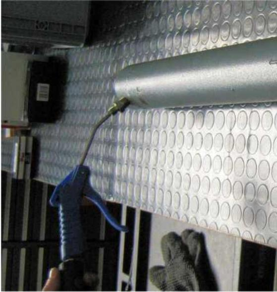
Avec un pistolet, pousser le piston au maximum, jusqu'à la fin de course.
