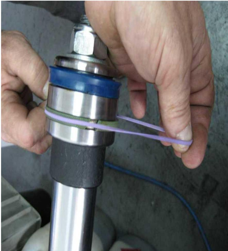
astuce: tenir le joint secondaire à l'aide d'un elastique et l'enlever durant l'introduction dans le cylindre.
