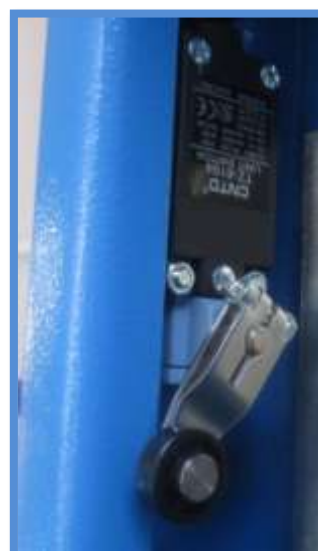
Braccio sonda a rullo, regolabile tramite allentamento della vite di fissaggio sull'albero dell'interruttore.
