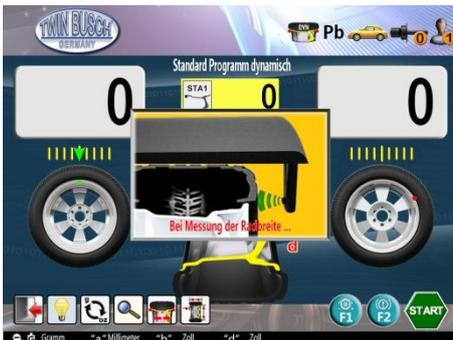
Abbildung 26: Automatisches Messen der Radbreite
