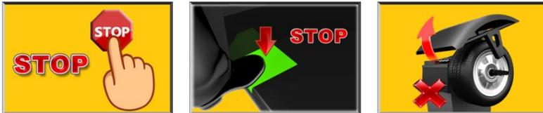
Abbildung 30: Stoppen des Messvorgangs (links: Stop-Taste auf dem Bedienfeld, mitte: Fußpedal betätigen, rechts: Schutzhaube öffnen)
