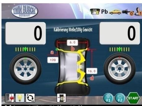
Abbildung 57: Gewichtskalibrierungsprogramm Schritt 1
