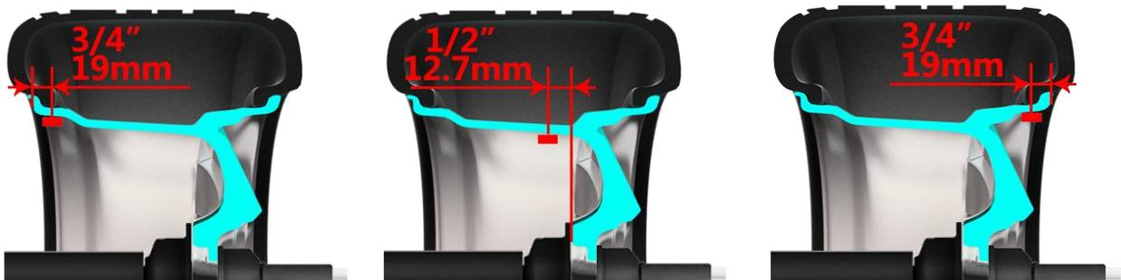
Abbildung 24: Klebepositionen (links: P2, mitte: P3, rechts: P4)
