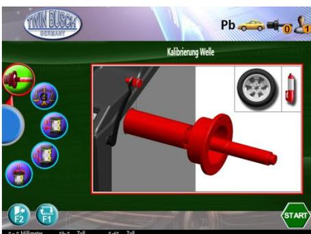
Abbildung 55: Wellennullkalibrierung
