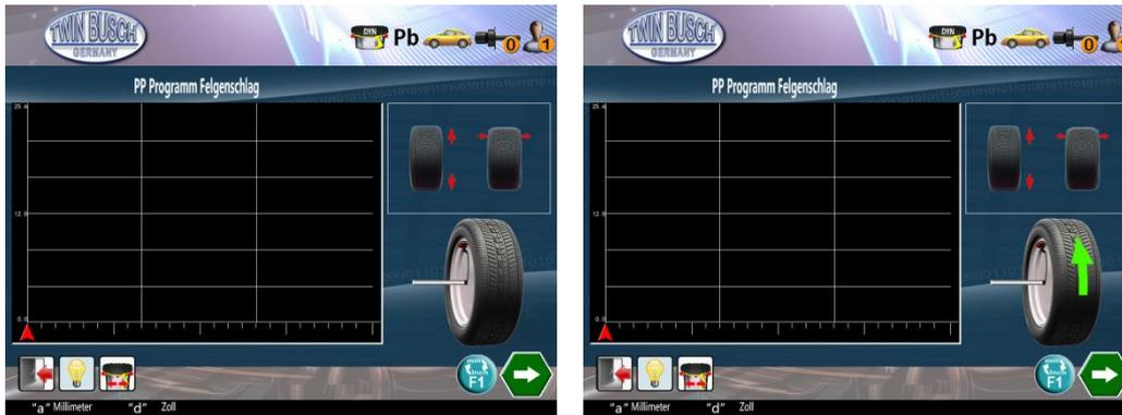
Abbildung 51: Felgenrundlauf und Axialschlag Messung
