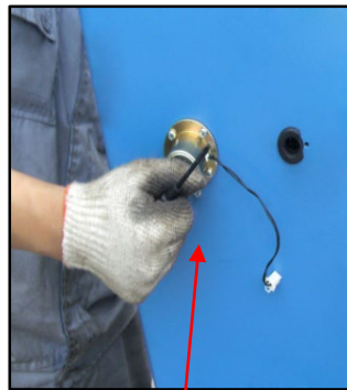
Elektromagnet an der Außenfläche der Säule
