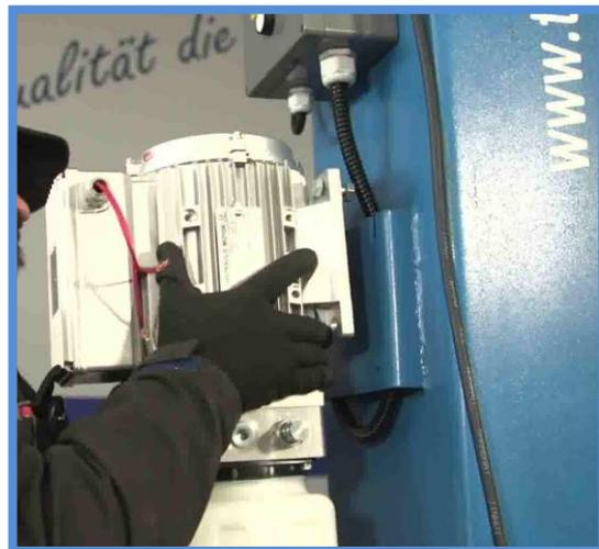
I cavi del motore devono essere collegati direttamente a questi raccordi. Per lavorare più comodo, puoi estrarre il condensatore a destra.
