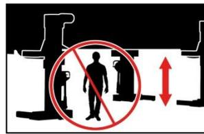
Il est interdit à toute personne de stationner sous le système de levage (pendant la montée ou la descente).
