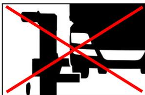
Veillez au positionnement correct et sécurisé des colonnes de levage (utiliser l'ensemble de la surface d'appui).
