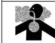
**ATMEN SIE KEINE KÄLTEMittel-EMISSIONEN EIN.** Dies kann zu Schleimhautentzündungen im Nasen-, Halsbereich und zu Schädigungen an den Augen führen. Sollte Gas aus der Anlage entweichen, muss der Raum gründlich gelüftet werden.
