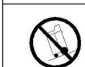
**DAS TW AC 100 MUSS BEI BETRIEB ZWINGEND AUF EINER EBENEN FLÄCHE STEHEN UND DARF AUF KEINEN FALL BEWEGT WERDEN (VIBRATIONEN VERMEIDEN)**
