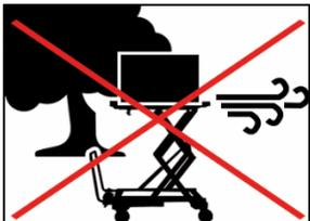
Nicht im Freien bei einer Windgeschwindigkeit höher als 14 m/s verwenden!
