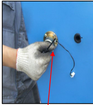
Electro-aimant sur la surface extérieure de la colonne
