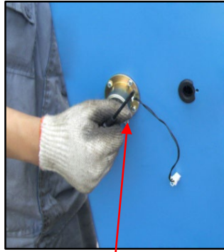
Elettromagnete sulla superficie esterna della colonna
