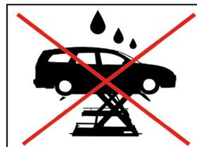
Hebebühne vor Feuchtigkeit schützen! Elektrische Anschlüsse müssen zwingend trocken sein!
